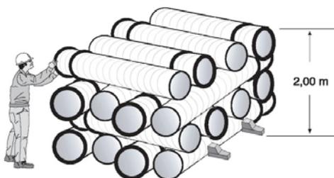
d) Almacenamiento a la intemperie: Cuando los tubos vayan a estar expuestos al sol durante más de 30 días, deben almacenarse bajo techo. No deben cubrirse con lonas o polietileno, pues esto provoca un aumento de temperatura que puede causar deformaciones. Por ello, se recomienda un techado que permita una buena ventilación a la tubería, como se aprecia en la siguiente figura.
