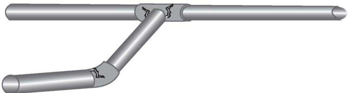
**FIGURA 13.14: FALLA POR INSTALACIÓN A TOPE**
