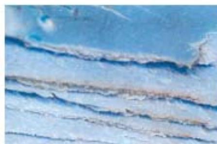
Estructura laminar observada tras rotura (x3)
